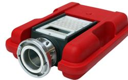
Der Schwimmsaugkorb Amphibio ist der aktuellste Neuzugang in unserer Fahrzeugausstattung. Er ermöglicht die Wasserentnahme aus allen offenen Gewässern, die eine Wassertiefe von mindestens 20 mm haben. Durch die schwimmende Ausführung wird das Ansaugen von Verunreinigungen und Fremdkörpern weitestgehend vermieden, was somit die Gefahr von Pumpendefekten nachhaltig minimiert.
