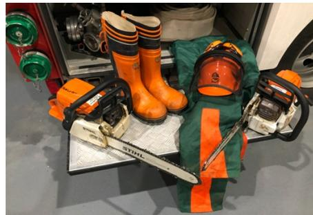
Kettensäge, Schnitenschutzstiefel/-hose, Schutzhelm
